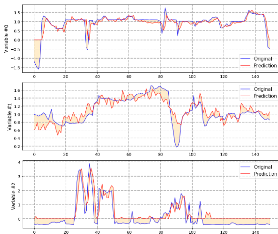
Fig. nr. 4 Ieșirea de predicție a rețelelor de memorie pe termen lung (roșu) față de valoarea reală care trebuie prezisă (albastru) pentru trei atribute ale motorului diesel pentru propulsie. Axa X reprezintă date normalizate provenite de la navă; Axa Y conține un index ordonat; Zona umbrită reprezintă eroarea de predicție
